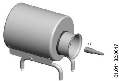
3. Вставить крышку насоса (03) в центрирующую часть фонаря (04).
