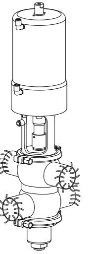
Installez la vanne de façon à faciliter toute inspection ou révision future. Laissez suffisamment d'espace autour de la vanne pour pouvoir effectuer correctement les opérations de révision, de démontage et de maintenance nécessaires.
