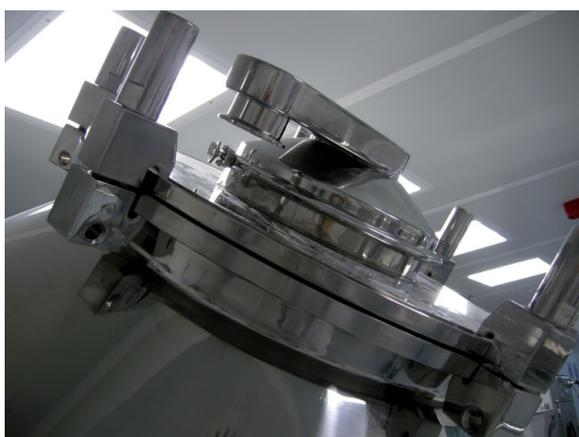
Отверстие для вакуумной загрузки
