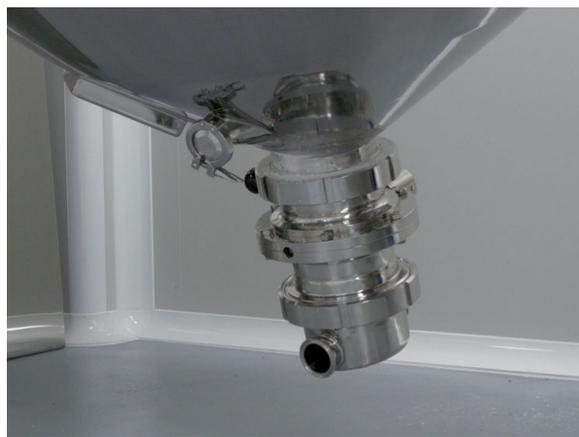
Отверстие для вакуумной выгрузки
